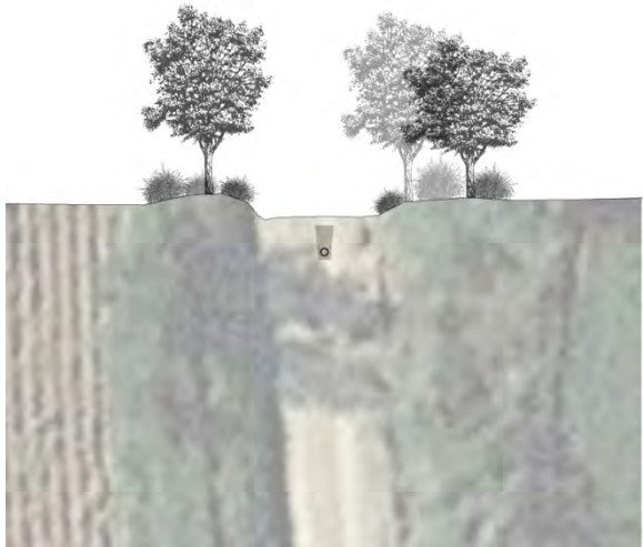
Secció transversal tipus pel camí. La canonada de 225 mm de secció és situa a una profunditat aproximada de 120 cm.
